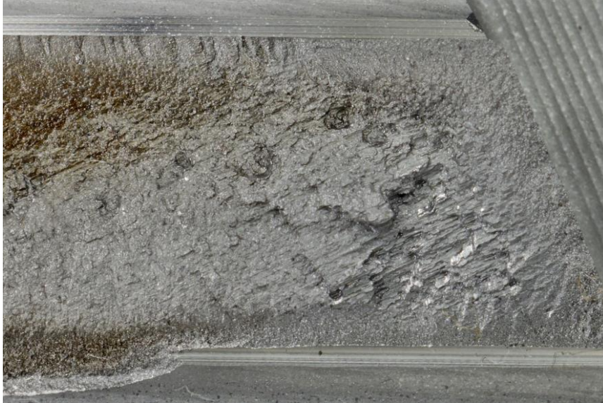
図 0.2-21 SCM420 鋼浸炭焼入れ歯車の歯の折損部に現れた介在物のクラスターと MnS 含有部の破面状態
