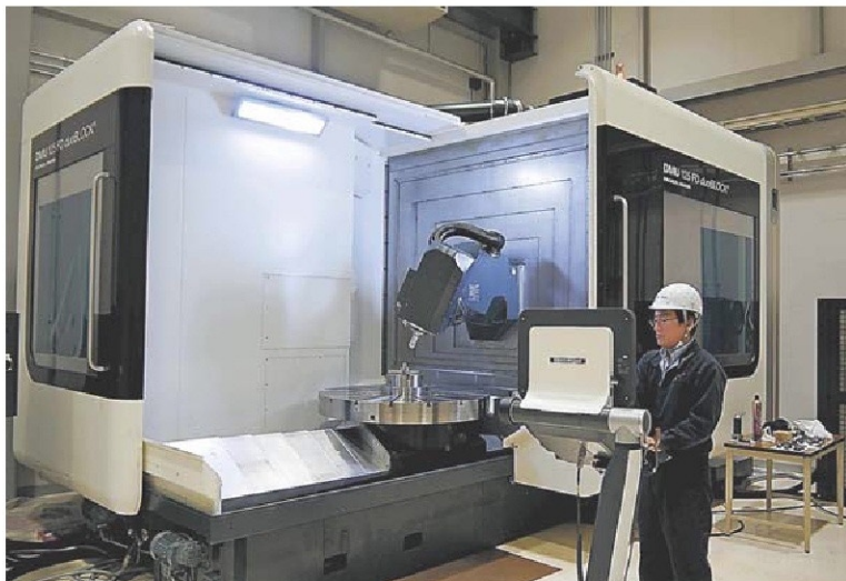
⑤機械基盤研究施設に導入されている最先端の加工機。部品の形を高精度に加工できる⑥今年で創設100周年を迎えた「応用科学研究所」(京都市左京区)
