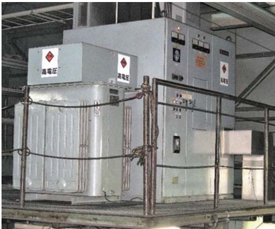
電子管式高周波発振器 (135kHz-100kW)
