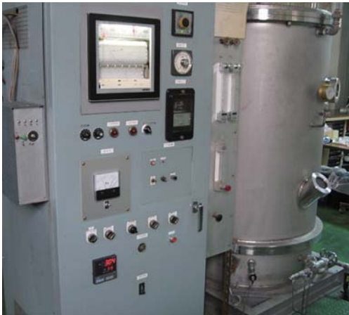
プラズマ窒化処理開始時の1号炉 (炉体は更新)
