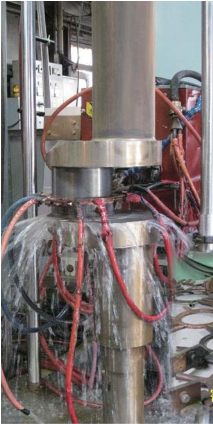
クランク軸高周波移動焼入れ (焼入れ後の歪みは極少)
