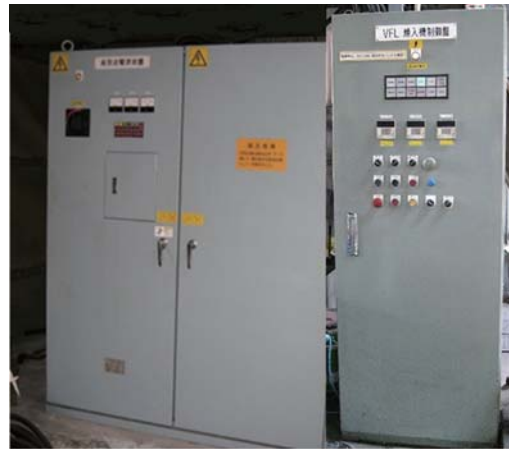
トランジスタインバータと制御盤 (100kHz-100kW)
