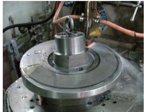
プレート斜面の高周波焼入れ専用機 材質：FC300
