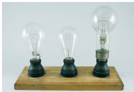
青柳研究所で開発された タングステン白熱電球
