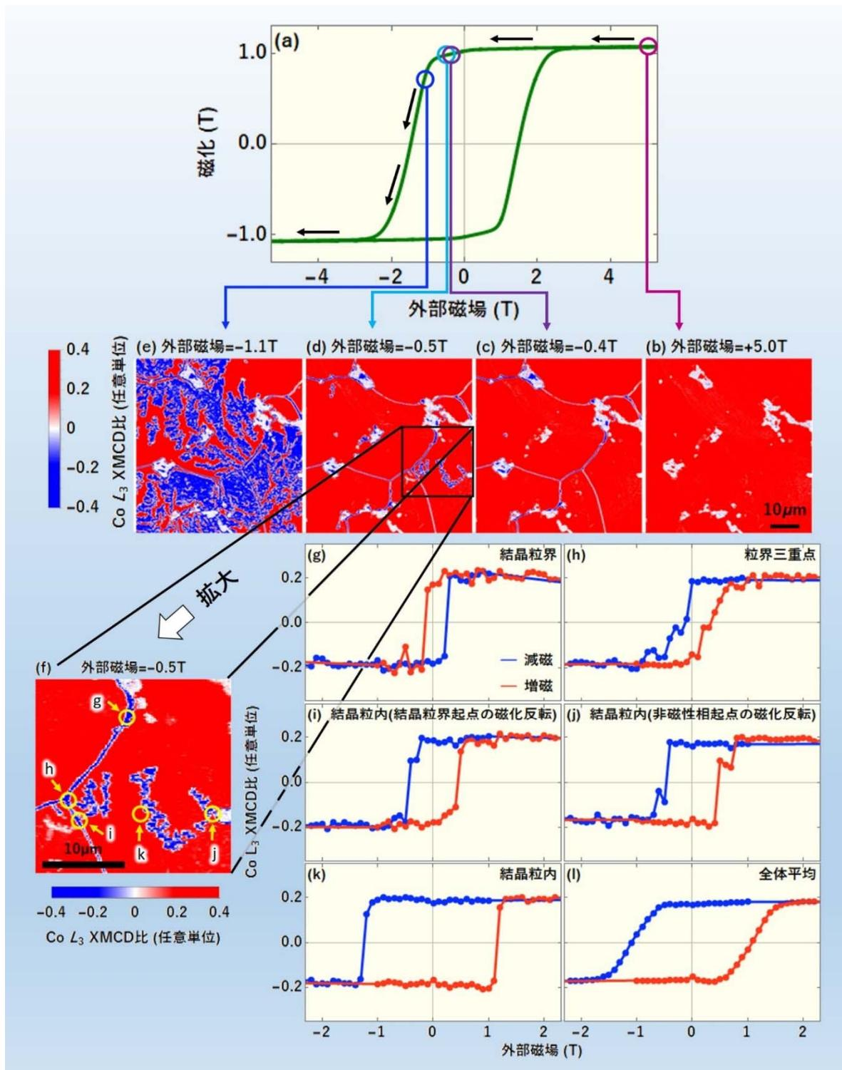
図1 異方性 $(\text{Sm, Ce})_2(\text{Co, Fe, Cu, Zr})_{17}$ 磁石のバルク磁化曲線(a)。 $\text{Co L}_3$  XMCD比を用いた磁区像の外部磁場依存性、外部磁場 $=+5.0$  T (b)、 $-0.4$  T (c)、 $-0.5$  T (d)、 $-1.1$  T (e)。結晶粒内に磁化反転が進展した領域の拡大図(f)。磁化曲線の場所依存性、結晶粒界(g)、粒界三重点(h)、結晶粒界から結晶粒内に向かって磁化反転が進展した位置(i)、非磁性相から結晶粒内に向かって磁化反転が進展した位置(j)、結晶粒内(k)、局所磁化曲線の全体平均(l)。
