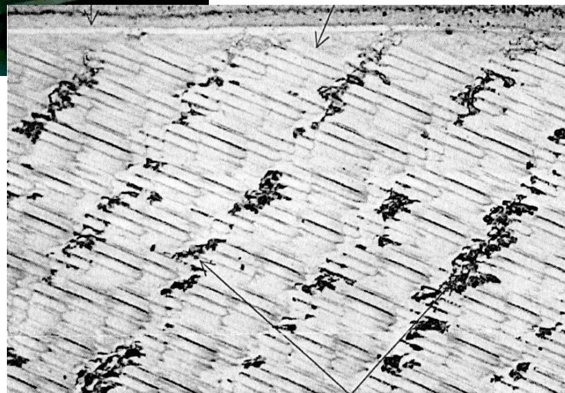
歯面粗さの畝部に生じた マイクロピッチング
