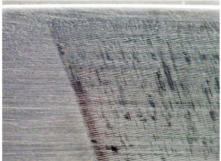
手間をかけてうまくエッジ処理された歯車の歯面：浸炭焼入研削はすば歯車、歯面上最大接触応力 2.1GPa,  $3.7 \times 10^7$  運転後（歯車材は上図と同一ロットの SCM420H、歯車諸元、熱処理条件、運転条件、運転試験機も全て同一）
