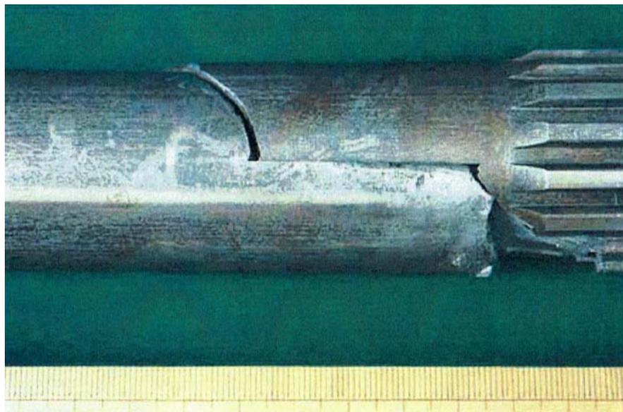
しかしながら、この材料はJIS規格に合格したミルシート付きの材料です。当研究所で開発した超多点自動HV硬さ測定装置で軸直角断面の硬さ分布を測定したところ、硬さのバラツキはとても正常とは考え難く、材料に明らかな問題があることが分かりました。
