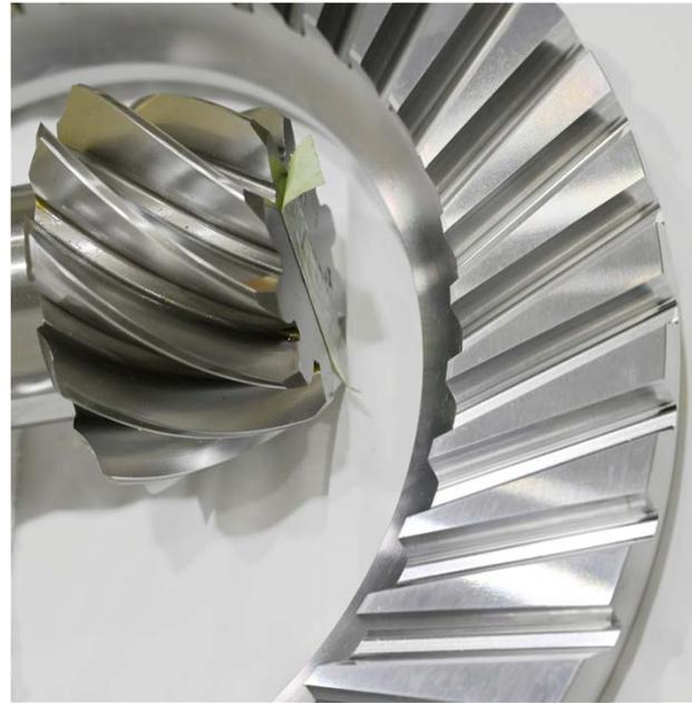
しかし、パス数が多い加工で歯数の多い大歯車を製作するには極めて長い加工時間を要し、専用加工機に比べて極端に加工能率が悪いことが、5軸制御マシンの欠点でした。
