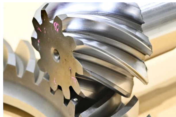
完成した球面インボリュートベベルギヤ
