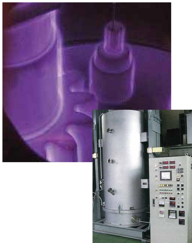
プラズマ窒化処理装置の例
