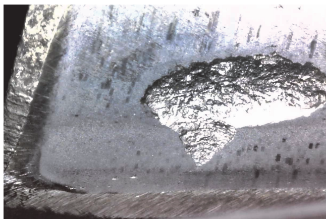
図1 自動車駆動用程度の小モジュール浸炭焼入れ歯車の歯面フレーキング損傷
