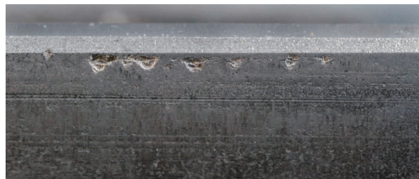
被動歯車歯元の熱的損傷
